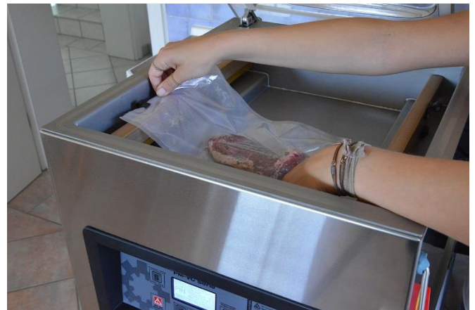
Einlegen des Vakuumbbeutel. Eine Klammer hält bei Bedarf den Beutel in Position auf der Siegelschiene.
