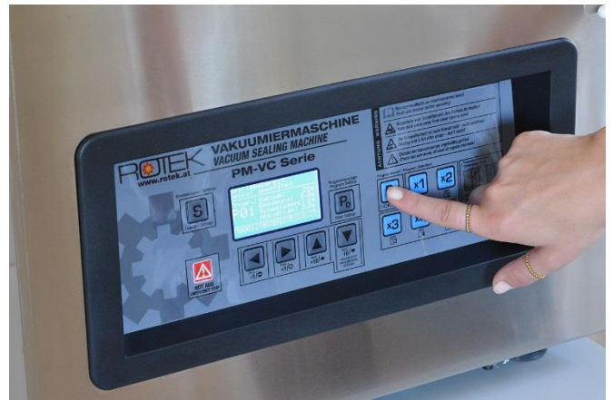
Starten des vollautomatischen Vakuumiervorgangs.
