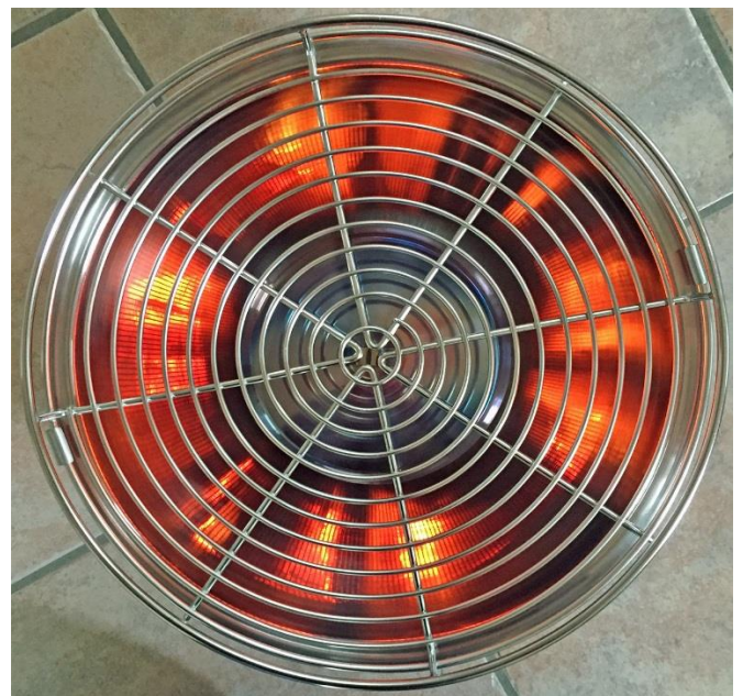
Blick von oben: Der Reflektor bündelt die Hitze auf den Rost
