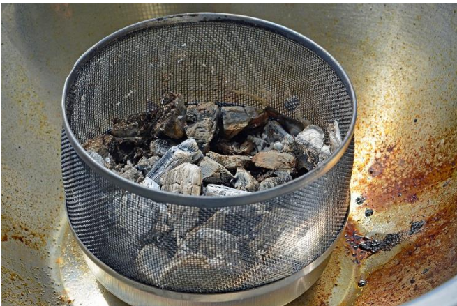
Verbleibende Holzkohle nach 35 Minuten auf Lüfterstufe II
