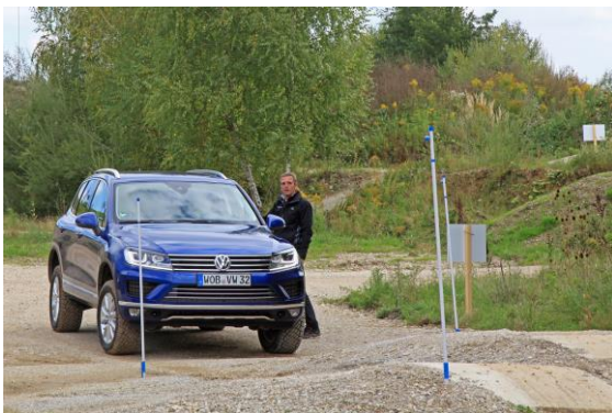
Der luftgefederte Touareg in der Fahrwerkseinstellung „Sondergelände“: 300 mm Bodenfreiheit lassen manch gestandenen Geländewagen neidisch werden.
