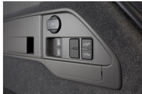
Extras wie die elektrische Entriegelung der Rücksitzlehnen und der Lademodus bei der luftgefederten Variante sind praktisch, kosten aber Aufpreis.
